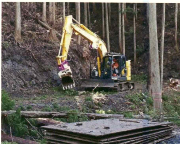
最新鋭フェラーバンチャーによる伐採作業
