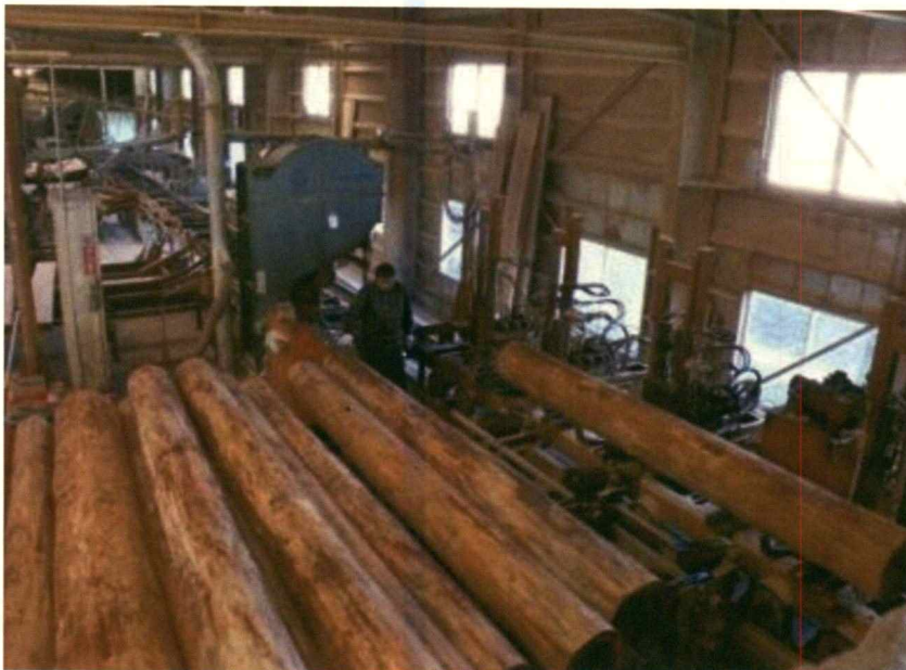
レーザー光線利用の丸太切断作業
